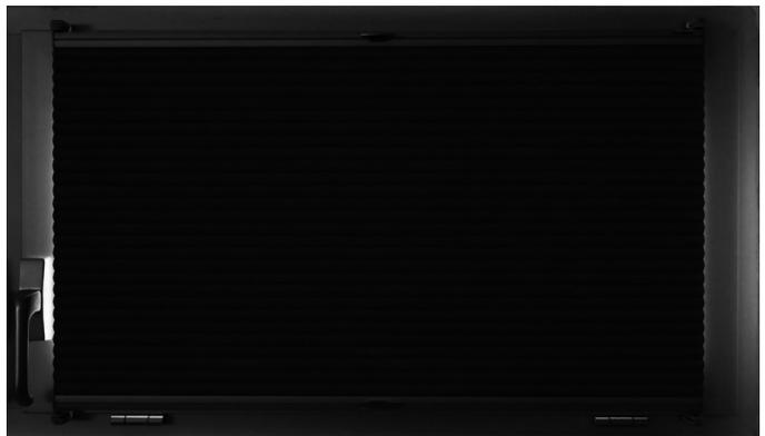
**DUETTE®**-Modell BB24 mit Abdunkelungsstoff, Montage auf dem Flügel, vor der 90°-Glasleiste (K1) eines Aluminium-Fensters – bei der Montage vor der Glasleiste unter Verwendung von W5-Trägern ist mit ähnlichem Restlicht zu rechnen.
