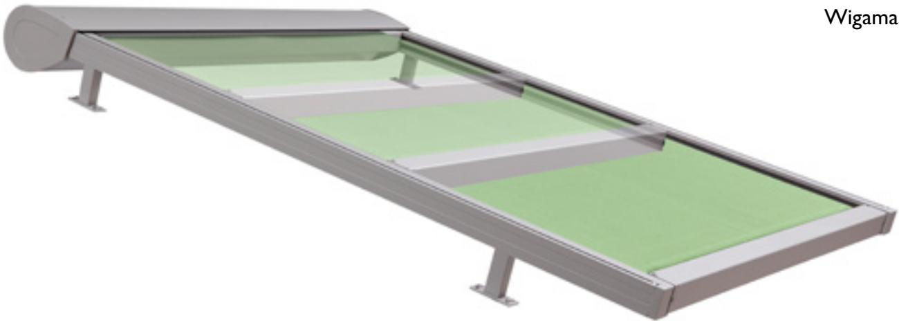
Stabile Ganz-Aluminium-Konstruktion für hohen Anspruch. Die Tuchbespannung erhöht sich mittels Spezialfedern beim Ausfahren der Anlage. Antrieb mit serienmäßigem Rohrmotor. Alle Profile und Systembauteile in Farbe weiß (RAL 9016), silber-metallic (RAL 9006), graualuminium (RAL 9007), anthrazit Struktur (RAL 7016), schwarzbraun
