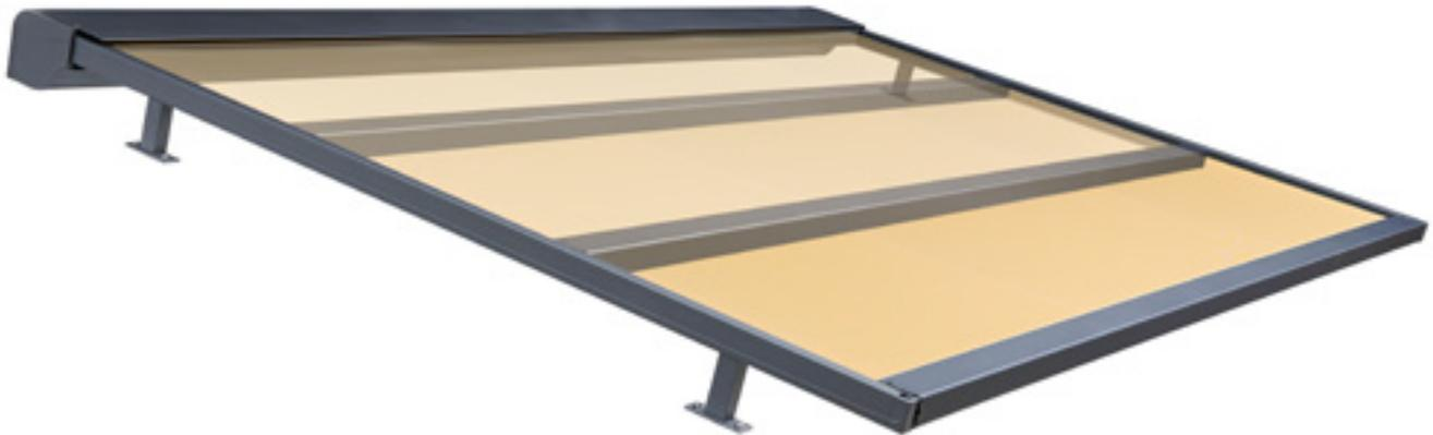
Stabile Ganz-Aluminium-Konstruktion für kleine bis mittlere Größen. Die Tuchspannung erhöht sich mittels Spezialfedern beim Ausfahren der Anlage. Antrieb mit serienmäßigem Rohrmotor. Alle Profile und Systembauteile in Farbe weiß (RAL 9016), silber-metallic (RAL 9006), graualuminium (RAL 9007), anthrazit Struktur (RAL
